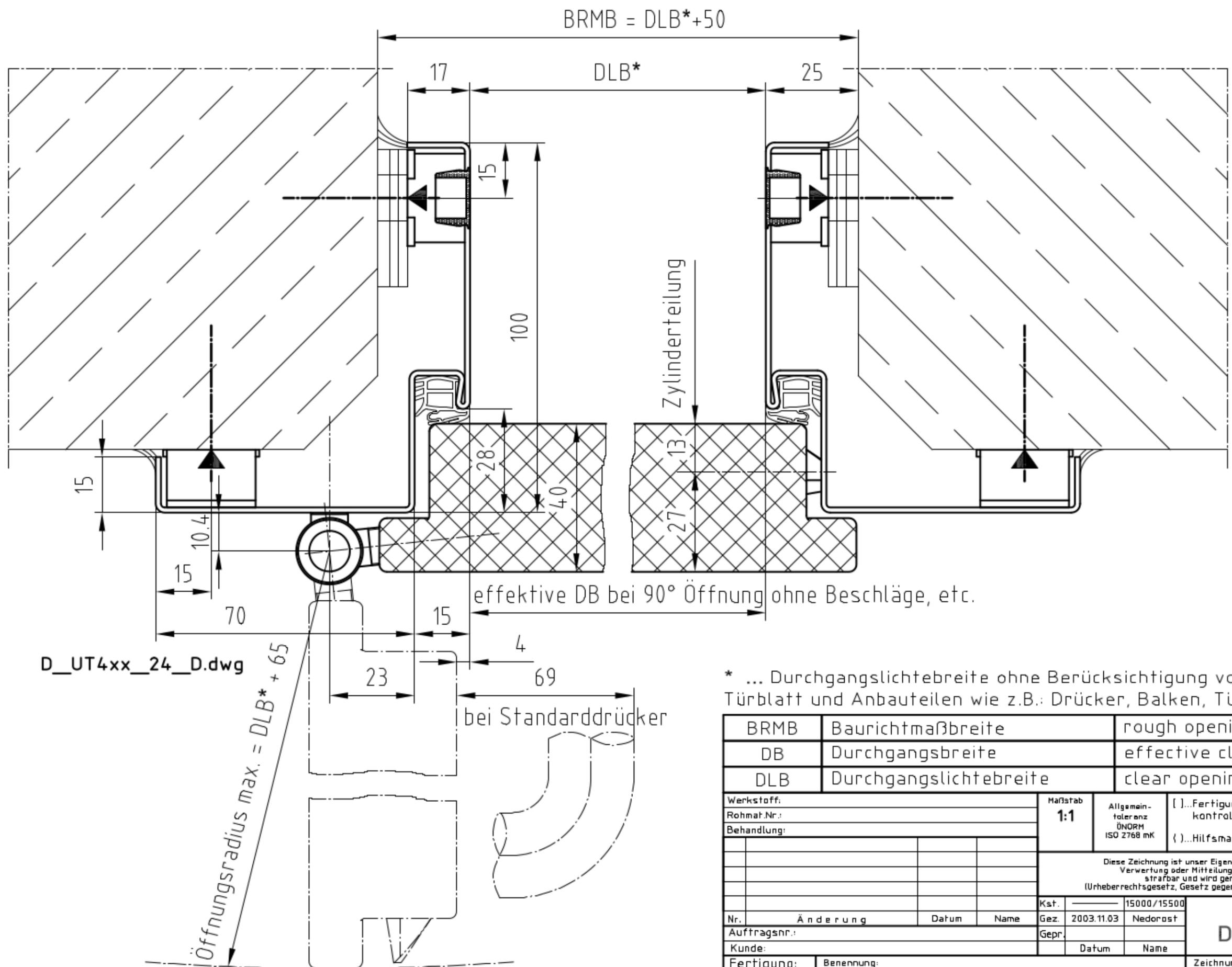
\* ... Durchgangslichtbreite ohne Berücksichtigung von geöffnetem Türblatt und Anbauteilen wie z.B.: Drücker, Balken, Türschließer, usw.
