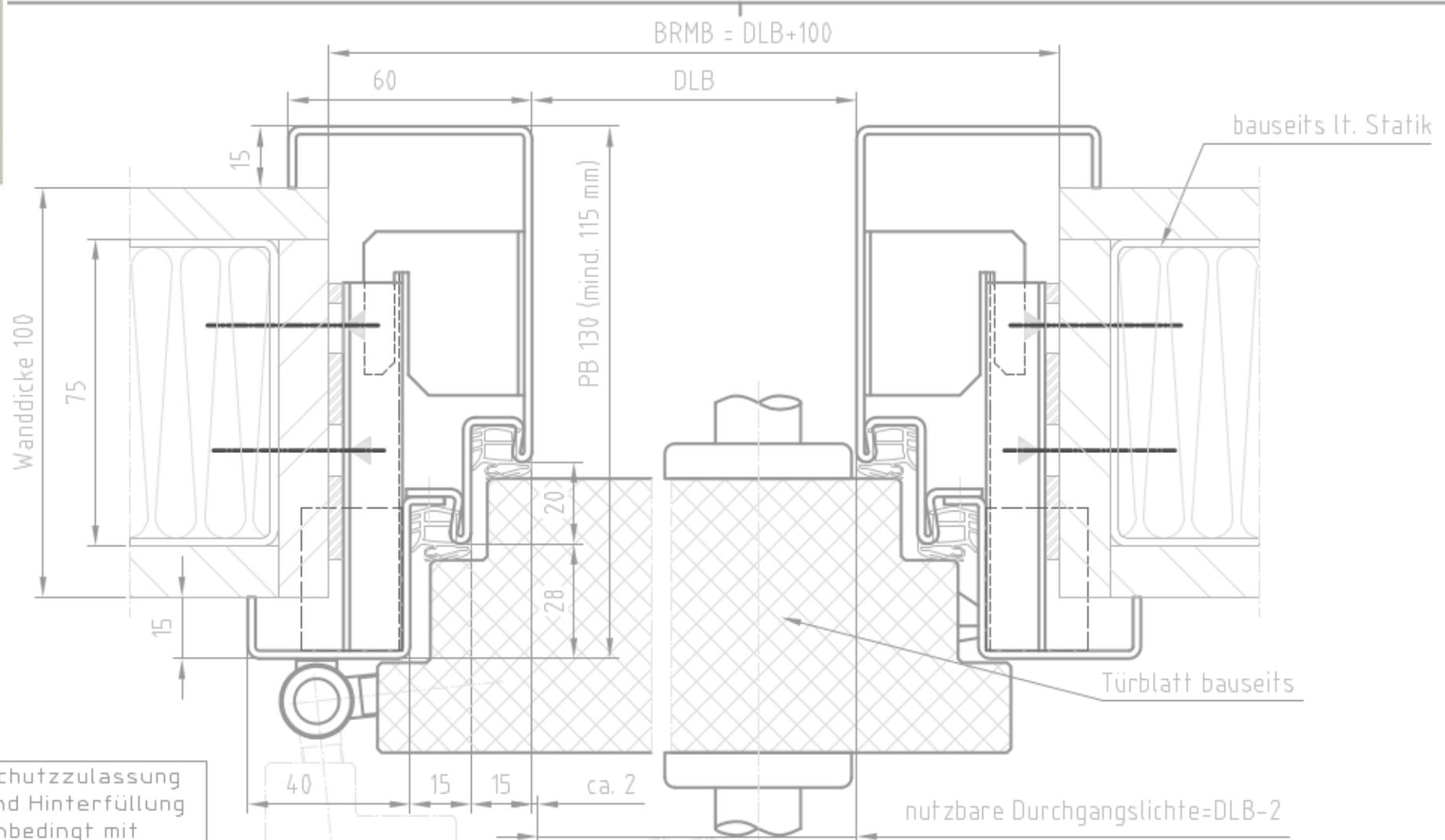
Feuerschutzzulassung EI230 und Hinterfüllung bitte unbedingt mit Türblatthersteller abklären!
