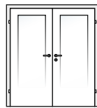
2-flügelig, mit/ohne Verglasung (Ausführung EI30 nur stumpf in Verbindung mit Stahlzarge möglich!)
